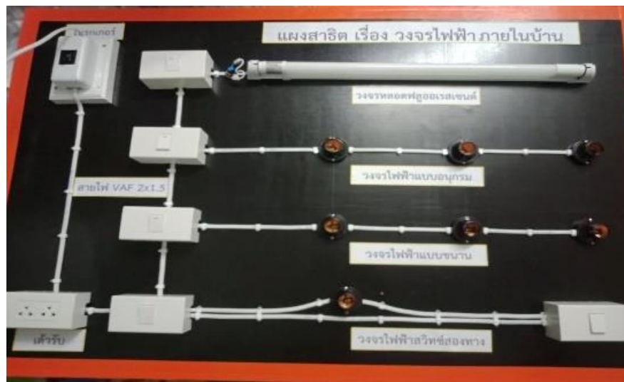
ภาพที่ 2 แผงสวิตติการต่อวงจรไฟฟ้าภายในบ้าน
